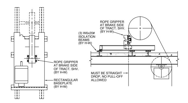
OVERHEAD MACHINE MOUNTING FOR ROPE GRIPPER LOCATED AT BRAKE SIDE OF TRACTION SHEAVE IS AVAILABLE FOR THE COMBINATIONS LISTED BELOW
